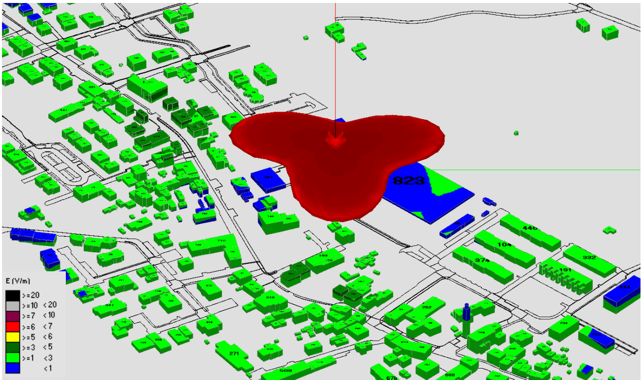
Fig. 102 Impatto elettromagnetico - Zona Campo Sportivo Giavenale - 0°/Nord
