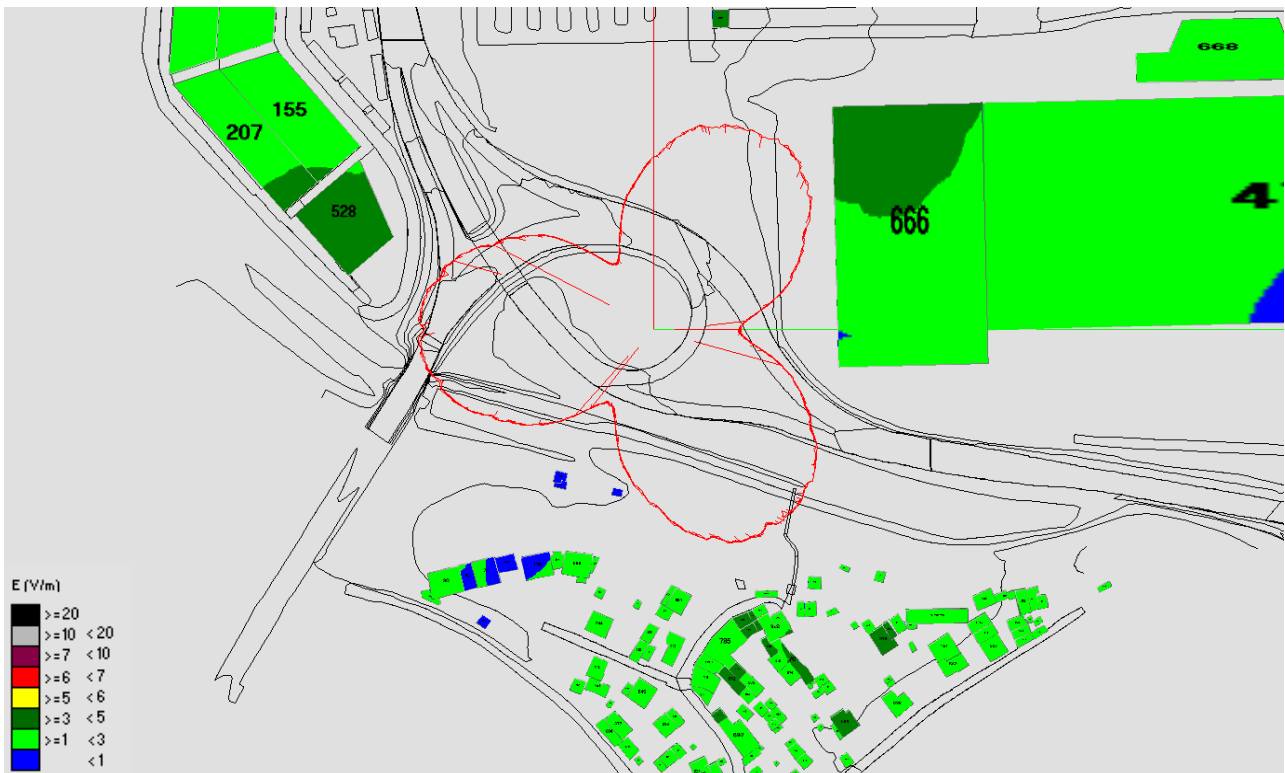
Fig. 108 Impatto elettromagnetico – Zona Area Via Maestri del Lavoro – Vista dall'alto
