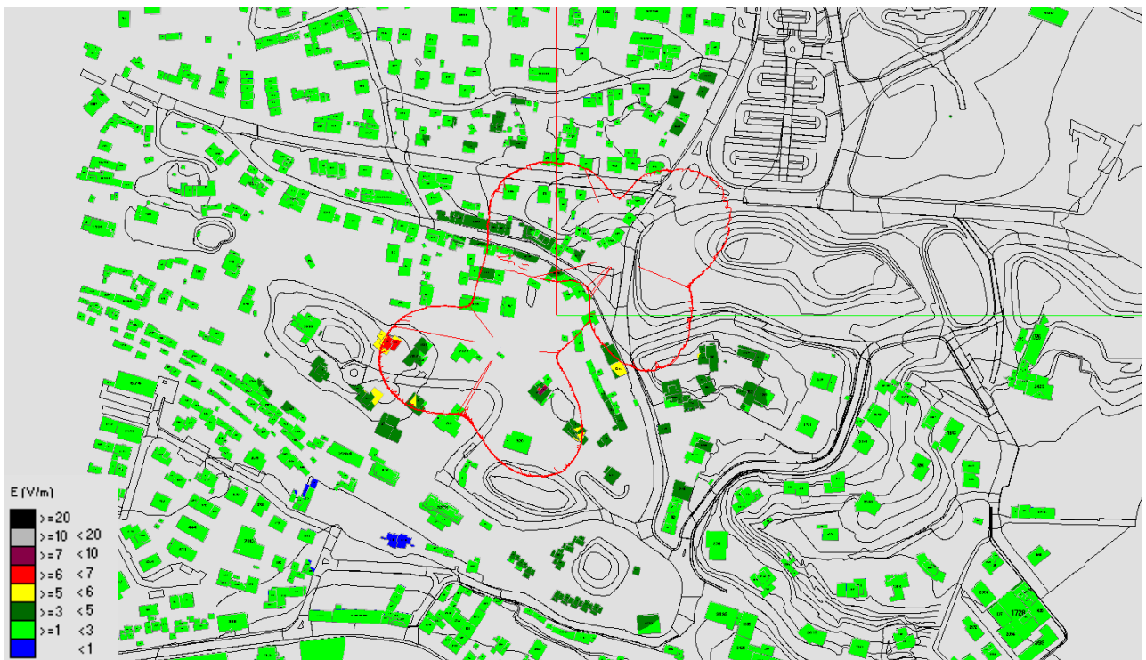
Fig. 33 Impatto elettromagnetico - Zona Via S.Niccolò Via Potara Via Toaldi - Vista dall'alto
