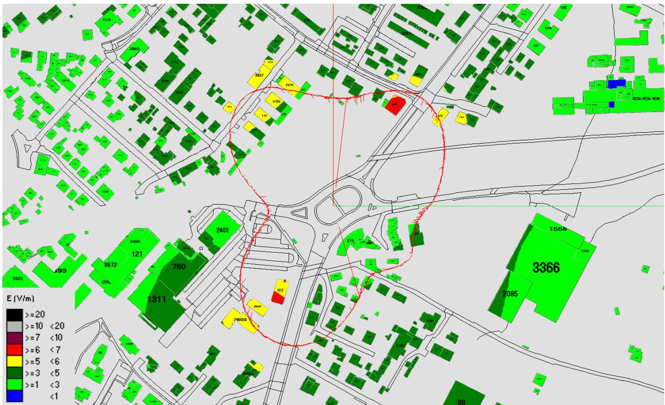
Fig. 58 Impatto elettrom. - Zona Rotatoria Viale dell'industria - Via Paraiso - Vista dall'alto senza solido
